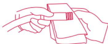
**4** | Retire a proteção da entrada da mangueira e da Turbina Power. Insira o lubrificante (com o seu conector já inserido) na extremidade da mangueira, por aproximadamente 4 segundos. Retire o excesso de lubrificante da mangueira e da Turbina Power com a toalha de papel. Monte todo o Sistema de Motores Power e deixe funcionar por 30 segundos, conforme no item **PROCEDIMENTOS PRÉ-OPERATÓRIOS**;
