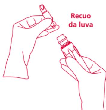
**2** | Insira a extremidade da Broca de Dissecção Mikro Macht – Modelo BAB01R<sup>(1)</sup> até o fundo da Peça de Mão Reta, gire levemente para que se encaixe e em seguida, solte a luva;
