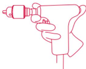
**2** | O mandril está instalado. O mandril é um adaptador para o profissional instalar brocas que não são comercializadas pela Razek Equipamentos.
