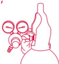
**2** | Fixe a mangueira do pedal ao regulador de pressão (esta conexão é feita com engate rápido) ou na rede, utilizando o adaptador adequado, conforme o item **MONTAGEM DO PEDAL AO REGULADOR DE PRESSÃO**;
