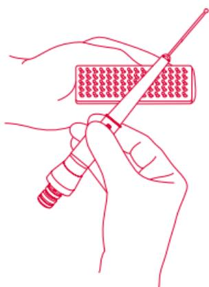
**3** | Enxágue as peças de mão em água corrente. A Broca de Dissecção Mikro Macht<sup>(1)</sup> deve estar inserida na peça de mão, evitando deste modo que a água entre no orifício superior;
