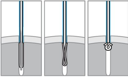
Figura 2 - Mecanismo de expansão do FastFit Anchor Razek.
