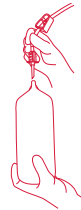
Figura 24 - Inserção de um conector para o recipiente de fluido do equipo em um recipiente de fluido.
